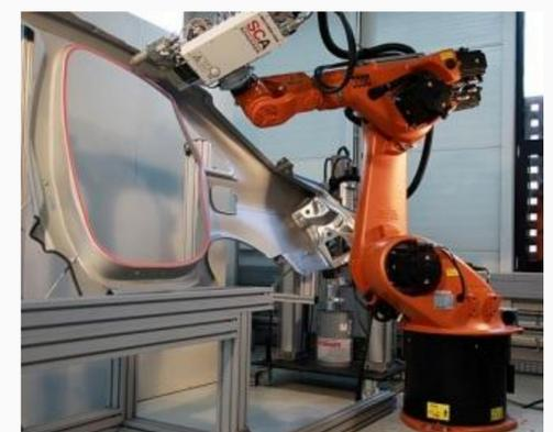
Figura 2: Adesivo Estrutural Aplicado por Braço Robótico
